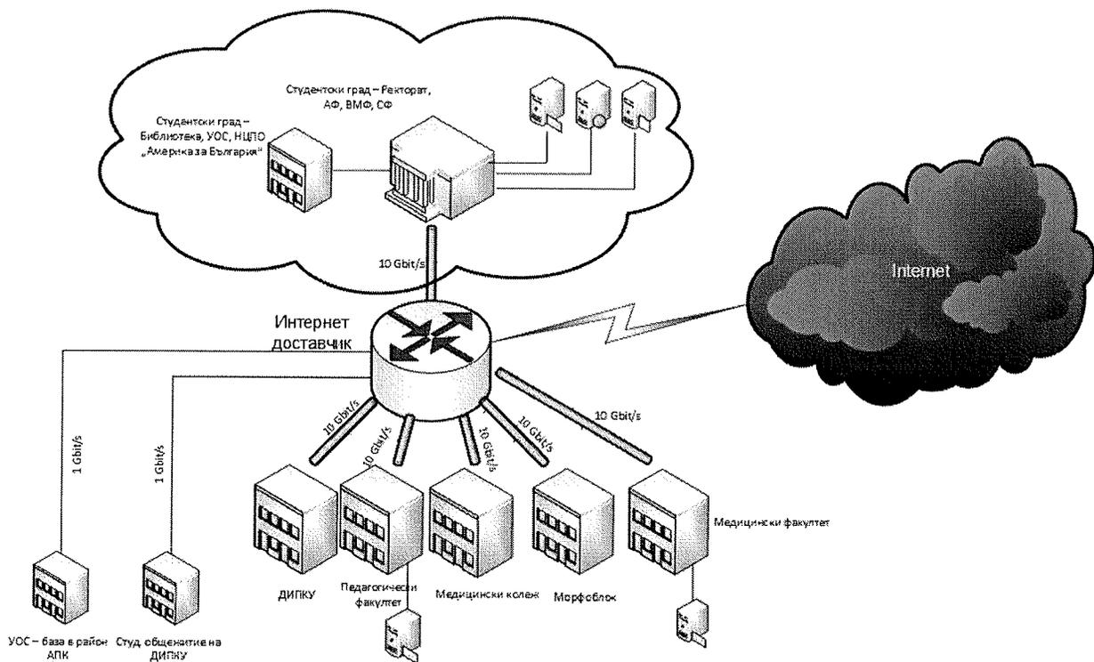
6.3. Логически свързаността да бъде следната: от LINUX сървъра на ТрУ са изградени VLAN със скорост по 1 Gbit/s до всяка база за интернет пренос и VLAN по 9 Gbit/s до всяка база за локални приложения.
